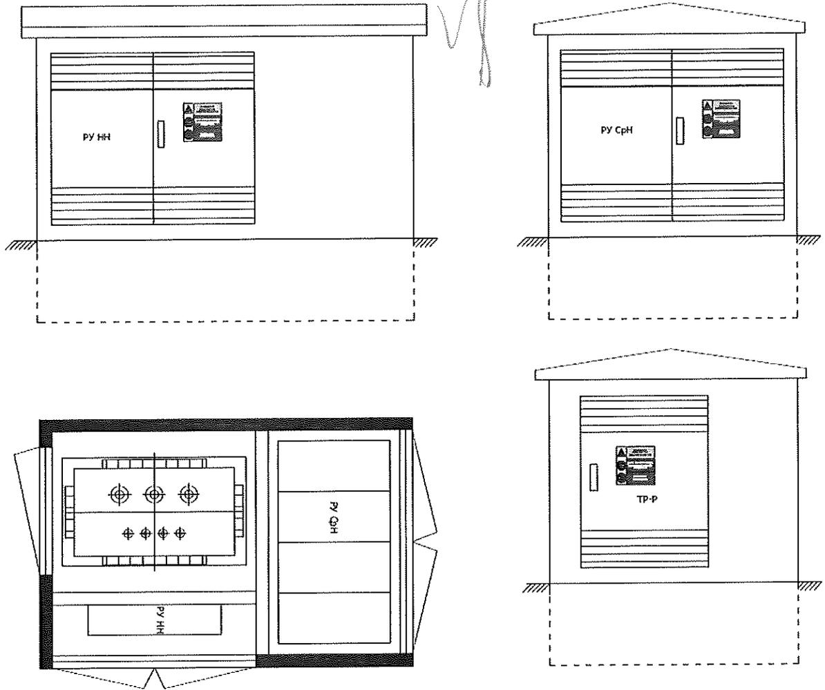
Фигура 1 – Строителна част и основни технологични съоръжения на БКТГ
